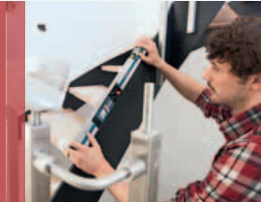
Combinado com a barra de medição **R 60 Professional**, o GLM 80 Professional converte-se num medidor de inclinações. A deteção da barra integrada faz com que o instrumento mude para o modo de inclinação quando é ligado. Com uma precisão de  $\pm 0,2^\circ$  é possível comprovar qualquer inclinação em obra.
