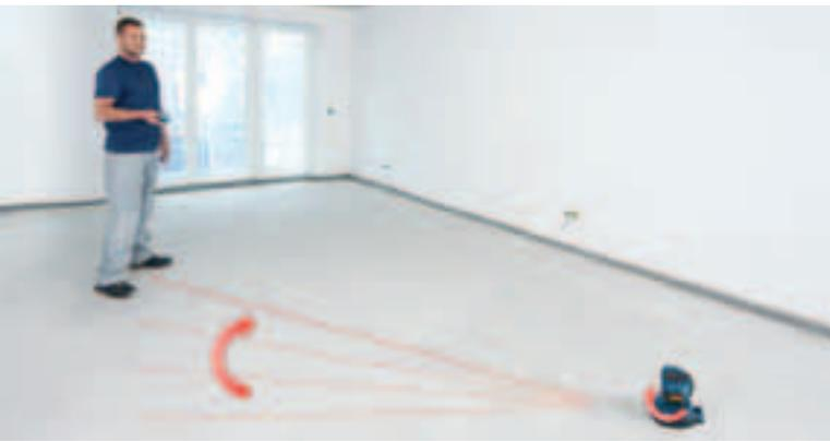
É possível rodar o GSL 2 Professional de forma elétrica por telecomando num raio de 360°. Deste modo, é possível controlar grandes superfícies de forma rápida e fiável.
