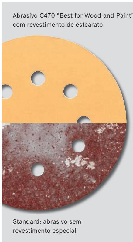
O revestimento com estearato comprovou a sua qualidade especialmente ao lixar tinta, verniz e massa de aparelho. Graças ao processo de revestimento único, o estearato é distribuído uniformemente sobre a liga de cobertura. Como resultado, o estearato prende o pó do verniz, extremamente fino, a grumos, que depois o tornam mais fácil de aspirar. Além disso, durante o lixamento de vernizes, o estearato tem um efeito refrescante sobre estes.
