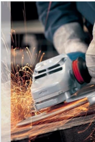
Os discos de corte da Bosch oferecem uma longa vida útil e rapidez no trabalho. Os discos podem ser utilizados no corte de peças de metal, pedra e Inox, conforme o modelo.
